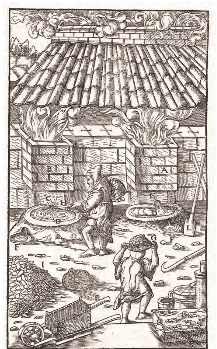
Z hutního koncentrátu transportovaného do hutě vzniklo po prvním tavení nečisté stříbro o obsahu kolem 70%, teprve po druhé tavbě tzv. přepalování vzniklo stříbro vysokého obsahu až 99%.
